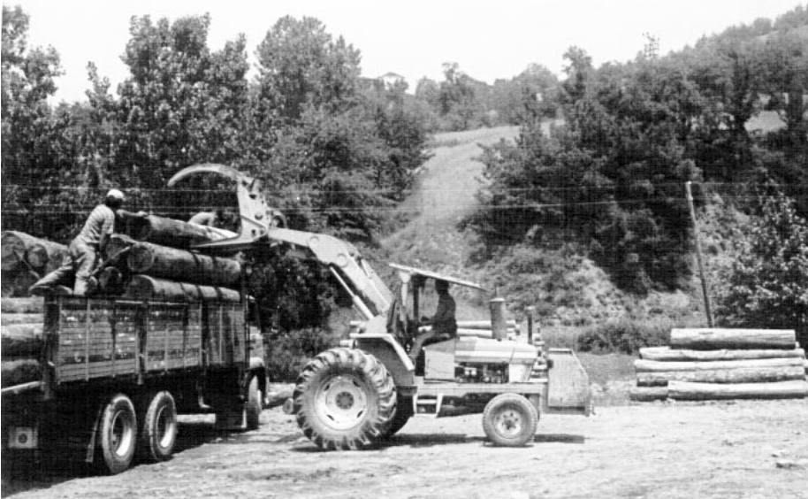
Şekil 2. Traktöre monteli ekipmanla yükleme
